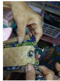
ภาพที่ 16 แสดงของรูปภาพการตอกหูกระเป๋า
