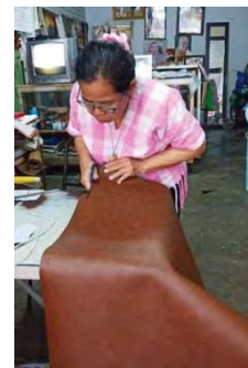
ภาพที่ 17 แสดงของรูปภาพการวัดหนังเทียม ตัดให้มี ขนาด 1 นิ้ว เพื่อนำไปทำสายกระเป๋า
