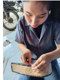
ภาพที่ 15 แสดงของรูปภาพการนำแต่ละชิ้นส่วนมาเย็บ ประกบกันให้ได้รูปผลิตภัณฑ์กระเป๋าจากต้นสาด
