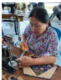
ภาพที่ 14 แสดงของรูปภาพการเก็บขอบไม่ให้เห็นสาด โดยการใช้ผ้าเป็นการเก็บขอบ
