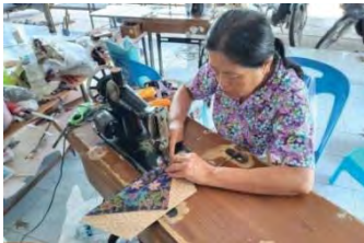
ภาพที่ 13 แสดงของรูปภาพการนำชิ้นส่วนที่เย็บติดกัน เรียบร้อยแล้ว จึงนำชิ้นส่วนนั้นไปเย็บติดกับผ้ารูป สามเหลี่ยม
