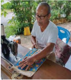
ภาพที่ 12 แสดงของรูปภาพการนำไปเย็บขอบให้มีกร ยี่ดระหว่างสาดกับกระดาษแข็งให้มีความแข็งแรงและ ตัดสาดส่วนที่เกินออกไป
