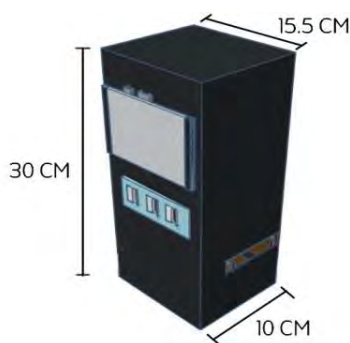
ภาพที่ 2 ภายนอกของเครื่องต้นแบบตรวจสอบบัตรยืนยันตัวตนด้วยระบบประมวลผลภาพ
