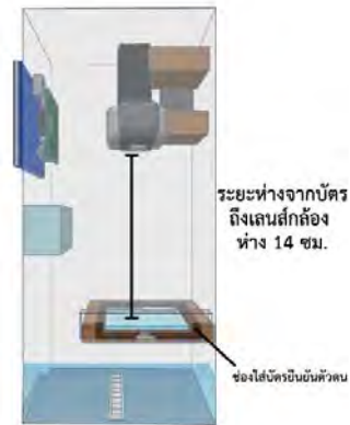
ภาพที่ 3 ระยะห่างจากบัตรยืนยันตัวตนถึงเลนส์กล้องภายในเครื่องต้นแบบตรวจสอบบัตรยืนยันตัวตนด้วยระบบประมวลผลภาพ
