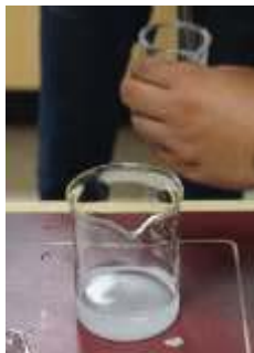
ภาพที่ 4 เติมน้ำกลั่นลงในบีกเกอร์ที่มีสารโซเดียมไฮดรอก ไซด์ (NaOH)
